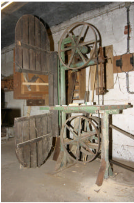
Bild 18: Mit dieser Bandsäge hat Engelbert Glasmacher aus Pappelholz die Sohlen für die Holzschuhe – „Hottsche“ – gesägt.
