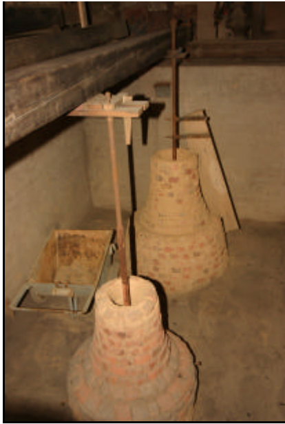
Vorbereitungen für den Glockenguss
